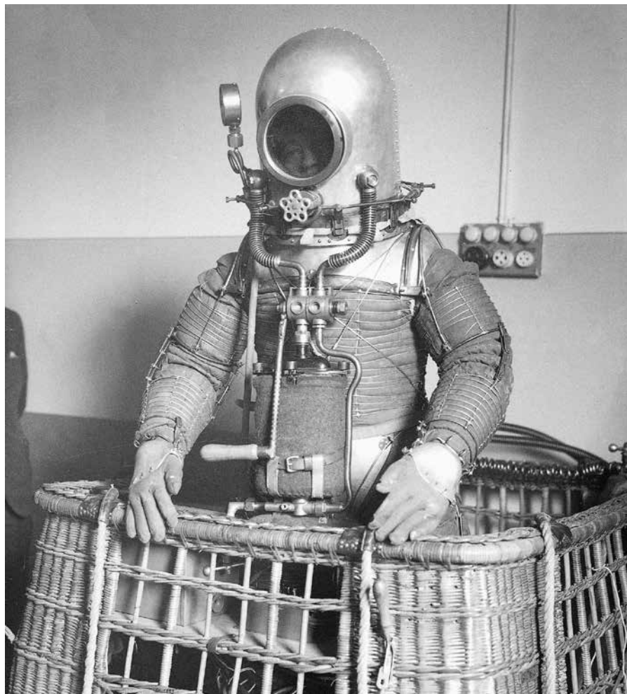
Emilio Herrera prueba la que es considerada como la primera escafandra espacial de la historia, proyectada por él mismo para alcanzar la estratosfera y realizar experimentos sobre el comportamiento del campo magnético terrestre y los rayos cósmicos, imposibles de llevar a cabo en una cabina presurizada. La ascensión estaba prevista para el final del verano de 1936. La Guerra Civil malogró el proyecto, que finalmente no pudo llevarse a cabo. La tela del globo acabaría reciclándose para hacer impermeables para las tropas.
